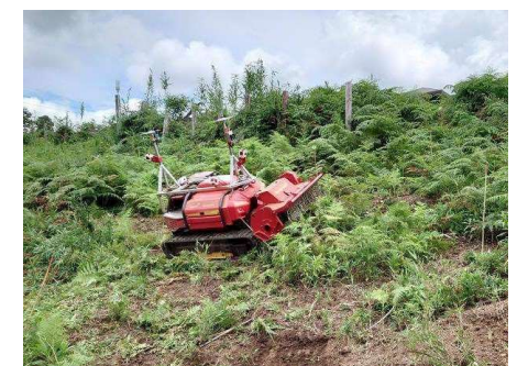
自動運転下刈り機械 (2027年頃実用化見込み) (千葉県君津市)
