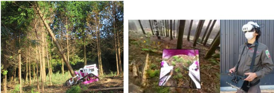
遠隔操作伐倒機械による伐倒の様子 スマートグラス内の画像とオペレータ
