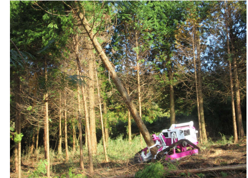
遠隔操作伐倒機械による伐倒の様子
