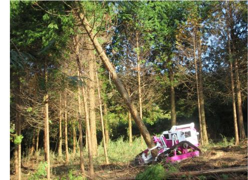
遠隔操作伐倒機械による伐倒の様子
