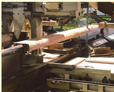
高原工場における平角生産の様子
