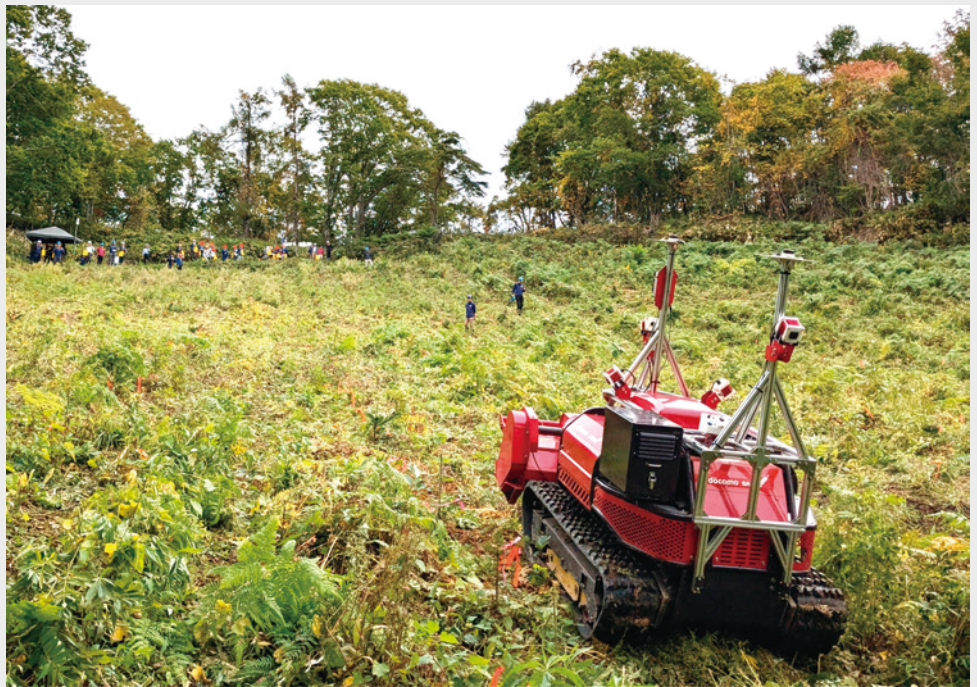
開発・実証中の自動運転下刈り機械(北海道)
