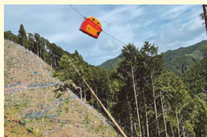
急傾斜地での架線集材・搬出
