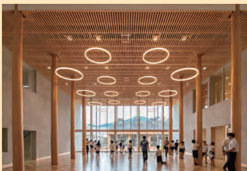
中津川市立福岡小学校 (岐阜県中津川市、令和5(2023)年7月竣工) 地元産ヒノキをふんだんに活用し、耐火性能とデザイン性を両立した木造校舎 (写真提供：株式会社川澄・小林研二写真事務所)
