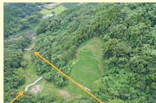
溪流の勾配を安定させ、土砂流出を抑制する治山ダムの設置
