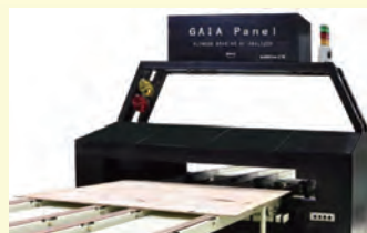
GAIA Panel-36 合板全面 (6面)AI検査装置 (橋本電機工業株式会社)
