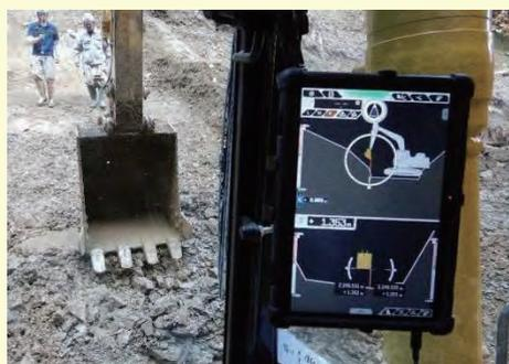
マシンガイダンス機能を搭載したバックホウのモニター
