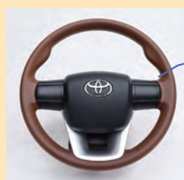
改質リグニン含有ポリウレタンを使用した 自動車用ステアリング(試作品) (写真提供：豊田合成株式会社)
