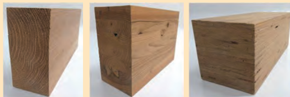
左：スギ製材(平角) 中央：スギと他の樹種を組み合わせた異樹種集成材 右：構造用 LVL
