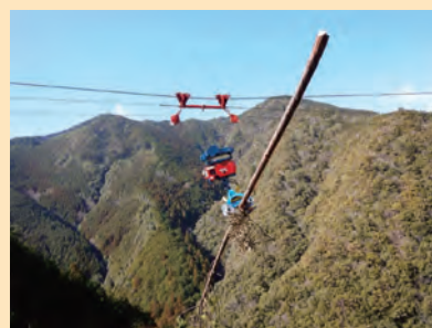
集材作業の遠隔操作が可能な架線式グラップルと油圧式集材機
