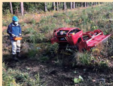
遠隔操作により下刈り作業を軽労化できる下刈り機械
