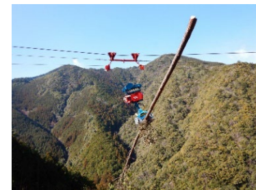
集材作業の遠隔操作が可能な 架線式グラブと油圧式集材機
