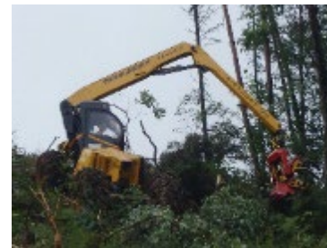
伐倒から造材まで行う 高性能林業機械（ハーベスタ）
