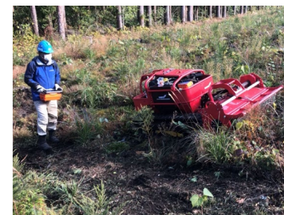
遠隔操作により下刈り作業を 軽労化できる下刈り機械
