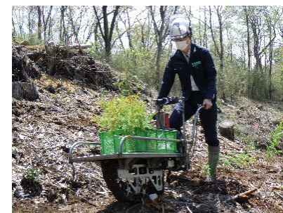
斜面での苗木運搬等を軽労化できる 電動クローラ型一輪車
