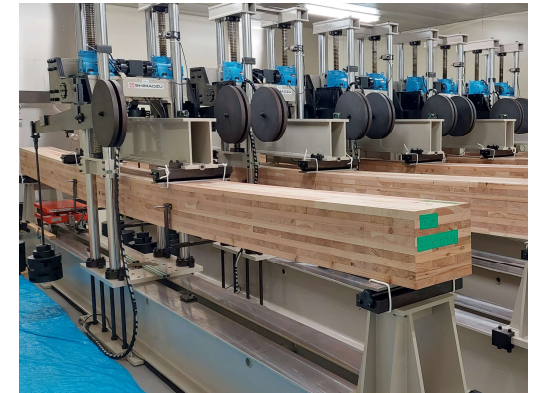
スギCLT(9層9プライ)の長期的な強度性能の測定 (写真提供：国立研究開発法人森林研究・整備機構森林総合研究所)
