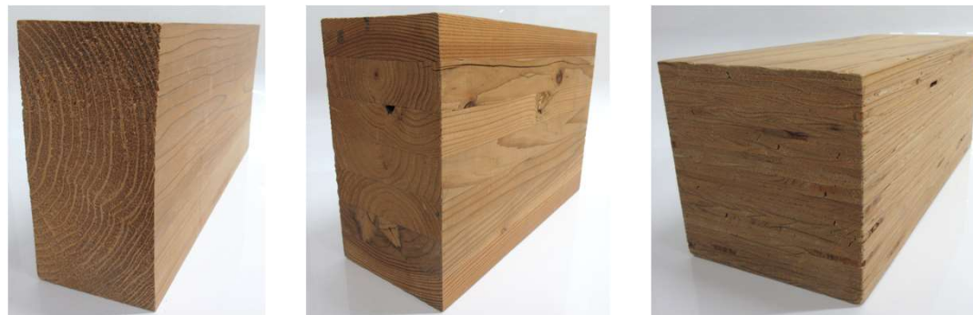
左：スギ製材（平角） 中央：スギと他の樹種を組み合わせた異樹種集成材 右：構造用LVL
