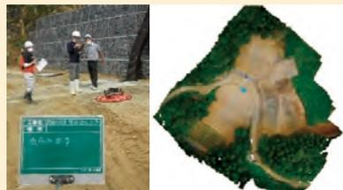
ドローンによる空中写真測量
