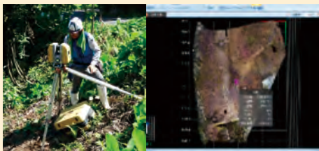
3Dレーザスキャナによる測量
