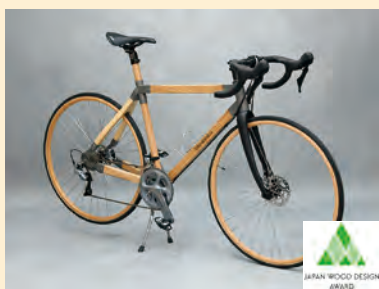
木製自転車スポーツタイプ TR-S型 E-Thruタイプ フレームに木材を使用した独創性の 高いスポーツタイプの自転車 (ハートフルデザイン部門優秀賞) (写真提供：カネモク工業株式会社)
