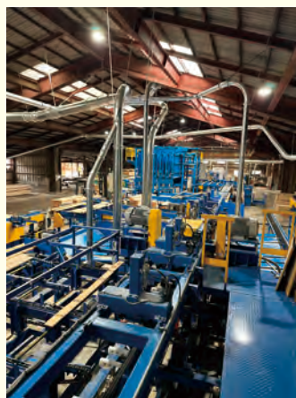
無人化機械による新たな羽柄材製造ライン
