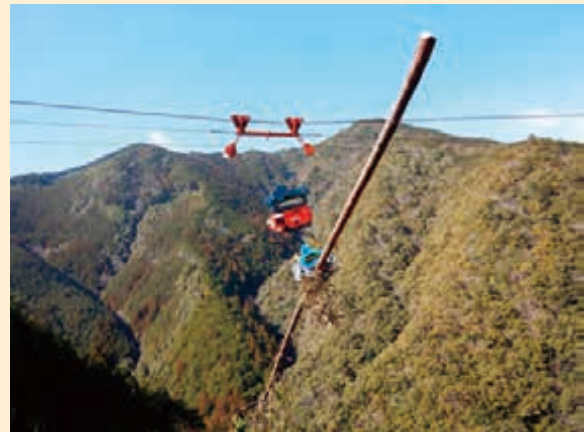
遠隔操作可能な架線式グラップルと油圧集材機による「新たな架線集材システム」を開発。
