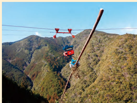
遠隔操作可能な架線式グラップルと油圧集材機による「新たな架線集材システム」を開発。
