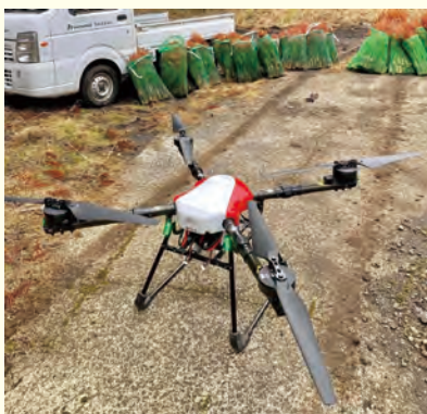
苗木運搬用のドローン
