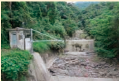
左：監視カメラと土石流センサーの設置 右上：カメラ映像 （桜島、鹿児島森林管理署）
