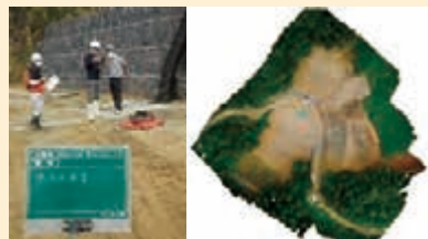
ドローンによる空中写真測量
