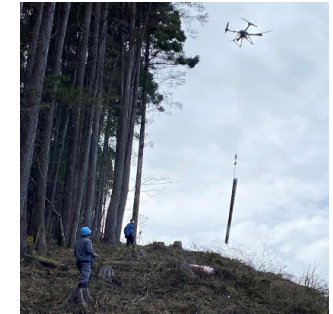
シカ防護資材運搬の様子
