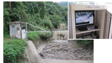
左：監視カメラと土石流センサーの設置 右上：カメラ映像 さくらしま （桜島、鹿児島森林管理署）
