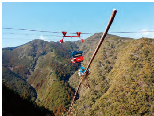
遠隔操作が可能な架線式グラブと油圧集材機による「新たな架線集材システム」を開発。
