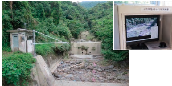
左：監視カメラと土石流センサーの設置 右上：カメラ映像 (桜島、鹿児島森林管理署)
