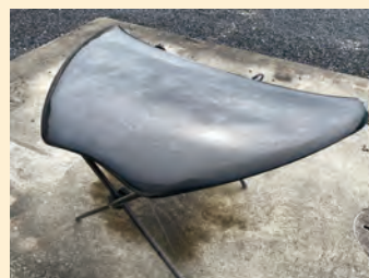
改質リグニン樹脂を用いた炭素繊維強化材を使用した自動車用外装材ボンネット（試作品） （写真提供：（株）宮城化成、国立研究開発法人森林研究・整備機構）
