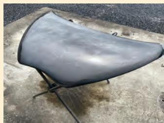
改質リグニン樹脂を用いた炭素繊維強化材を使用した自動車用外装材ボンネット(試作品)
