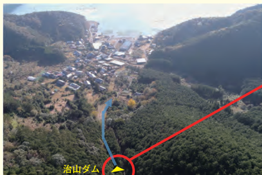
治山ダム(昭和62(1987)年度施工)による流木の流出等の抑制効果(三重県紀北町)
