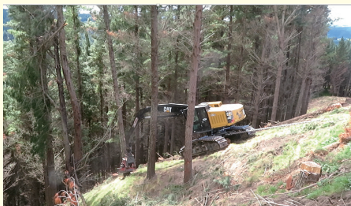
ウインチ付きエクスカベータ（油圧ショベル）にワイヤーで牽引され、急斜面で伐倒作業をするハーベスタ
