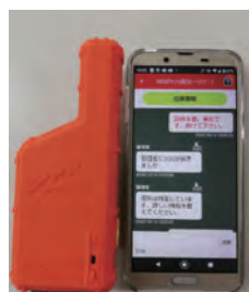
左写真：LPWA子機（左）。スマートフォン（右）を連携させ、専用アプリによる文字のやり取りも可能
