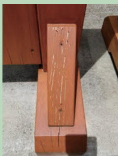
CNF配合下塗り塗料を使用した場合と使用しない場合の 24か月後の塗膜の状態
