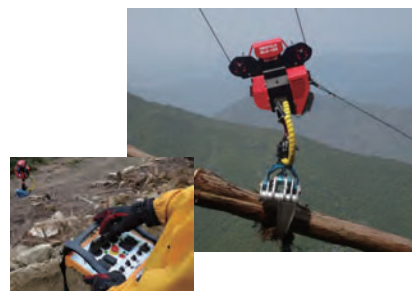
架線を走行するグラップルに搭載したカメラ映像を見ながら、集材作業を遠隔操作
