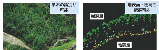
航空レーザー計測結果
