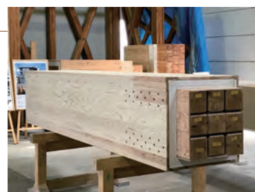
スギ製材の「束ね柱」
