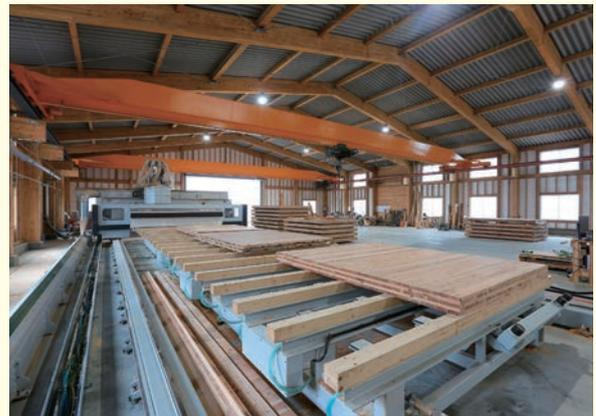
CLT加工機を導入した新工場棟
