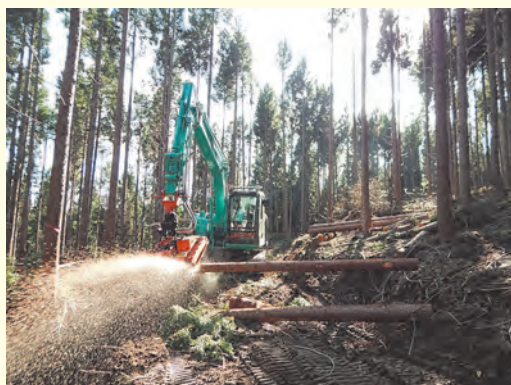
搬出間伐事業地での造材の様子
