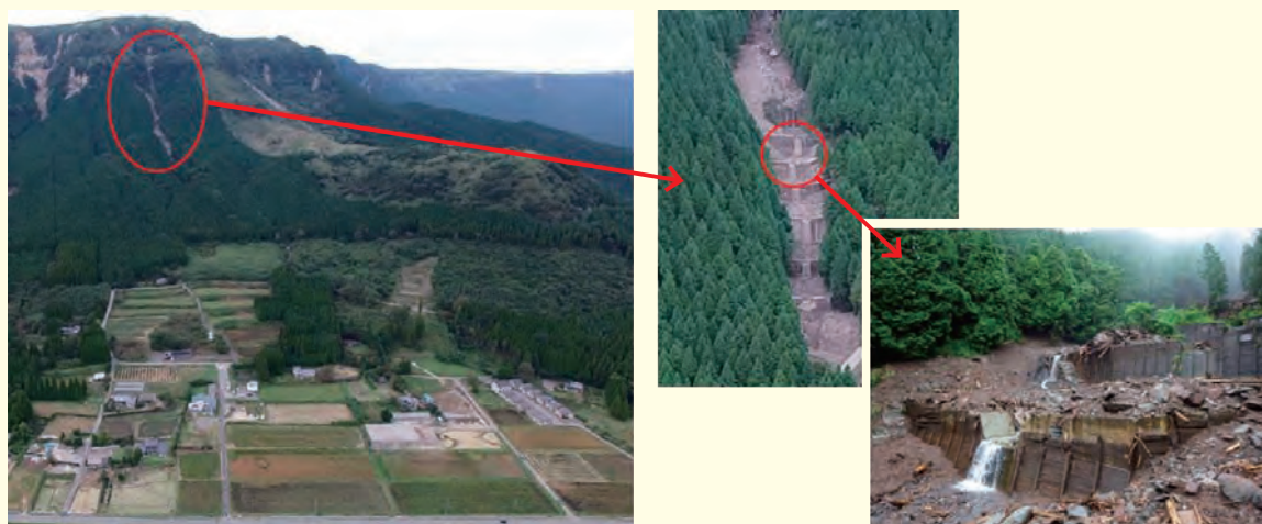
治山ダムによる土砂流出の抑制効果(熊本県阿蘇市三久保字丸敷地区)
