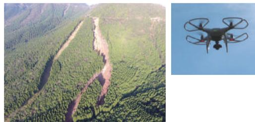
大隅森林管理署では、平成28(2016)年9月に鹿児島県に上陸した台風第16号による山地災害の被害調査において、小型無人航空機を活用。安全な場所からの遠隔操作による空中撮影により、機動的かつ効率的な調査が可能に。
