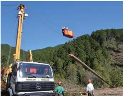
天竜森林管理署では、架線系による「一貫作業システム」（集材とコンテナ苗の運搬・植栽を一体的に行うシステム）の実証試験を実施。同システムの普及を図るため、現地検討会とシンポジウムも開催。
