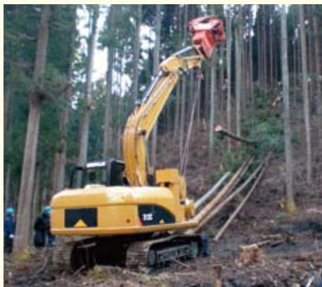
アームをタワーとして使用し、主索を用いない簡易な架線による集材機
