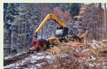
林内走行伐倒・造材機械
