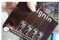
改質リグニンの用途として期待される電子基板
