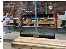
米国検査機関でのスギの強度試験 (2024年6月、オレゴン州立大学)
