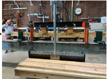
米国検査機関でのスギの強度試験 (2024年6月、オレゴン州立大学)
