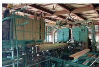
横架材の加工機械
