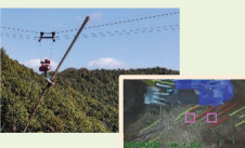
AIにより木材を検知する自動運転集材機械
