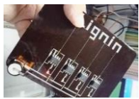
改質リグニンの用途として期待される電子基板
