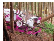
遠隔操作の伐倒機械
