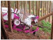
遠隔操作の伐倒機械
