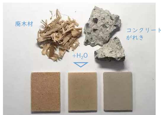
下がボタニカルコンクリート。左の方が廃木材を多く含む。
