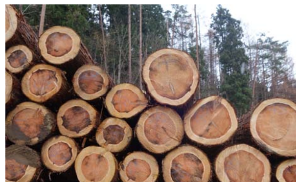
カミキリムシの幼虫による木材の変色や節などの意匠も内装利用を許容することで、地元の木材のみで約9割の供給量を確保。
